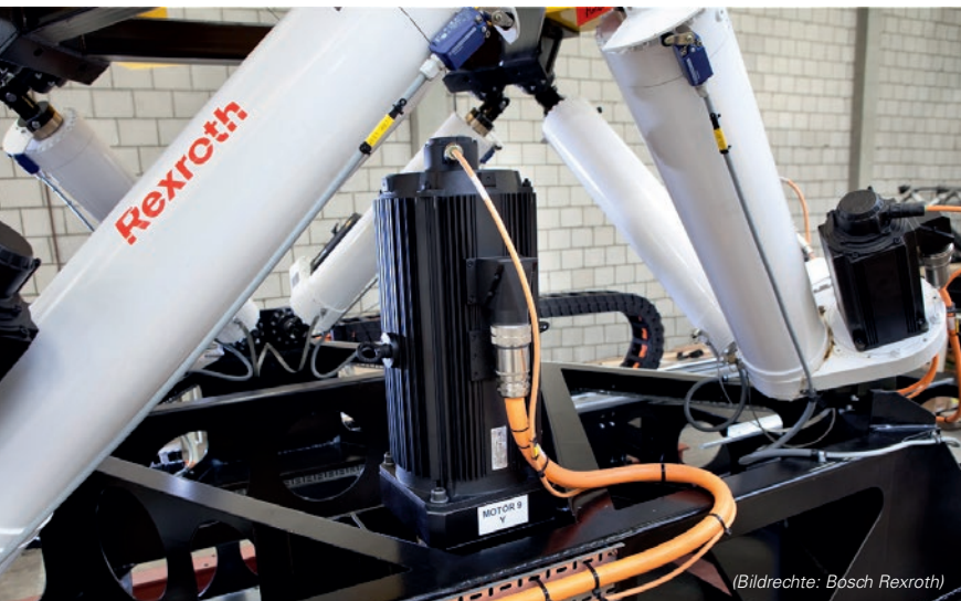
AC Servomotoren bewegen die Hexapoden über das Gantry-System in Y-Richtung (Bildrechte: Bosch Rexroth)
