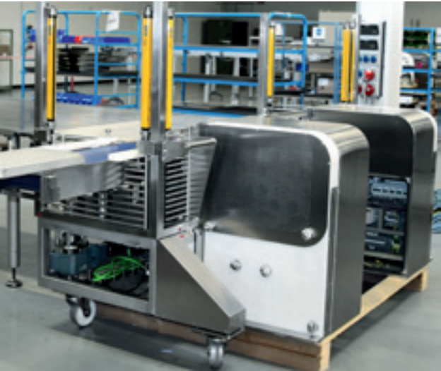
Ein mobiles ALUSTM der neuen Serie in der Montage/Testphase: Links der Puffertisch mit Förderband, darunter außerhalb des hygienisch kritischen Bereichs die integrierten Lexium ILM62 Antriebe samt Vernetzung.
