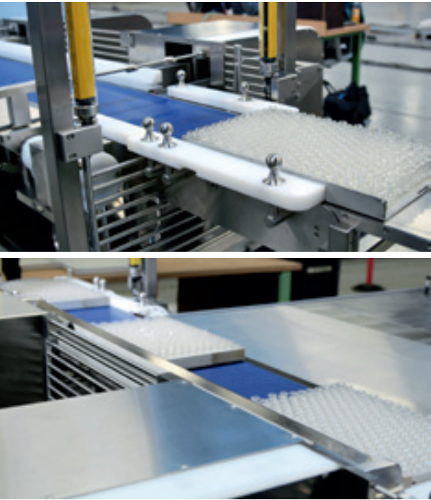
Die Vials – hier auf optional verwendbaren Tablets – fahren ein und werden dann durch einen Schieber über die Brücke in den Gefriertrockner geschoben bzw. nach dem Gefriertrocknen läuft der Prozess umgekehrt.
