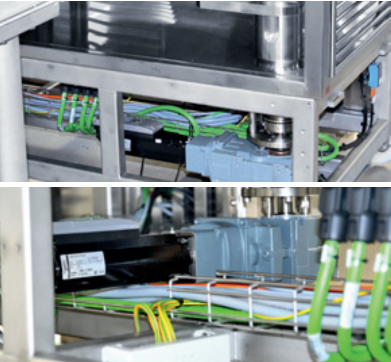
Im Unterbau des ALUSTM, außerhalb des hygienerelevanten Bereichs, sitzen die mit Verteilerboxen und Hybridkabeln vernetzten Lexium 62 ILM-Servoantriebe.
