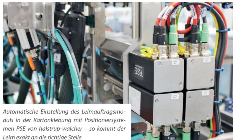
*Automatische Einstellung des Leimauftragsmoduls in der Kartonklebung mit Positioniersystemen PSE von halstrup-walcher – so kommt der Leim exakt an die richtige Stelle*
