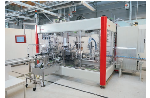
Bild 2: Endverpackungsmaschine mit modularem Aufbau: Die Funktionalität entsteht durch individuelle Konfiguration von mechatronischen Einheiten im Maschinengestell.
