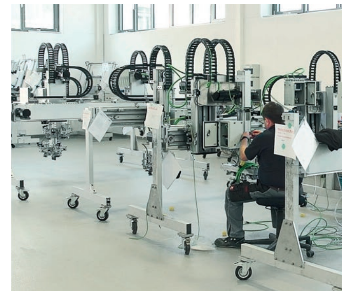
Bild 1: Mechatronische Module mit kompletter Servoantriebstechnik aus dem Baukasten auf rollbaren Montage- und Transportgestellen
