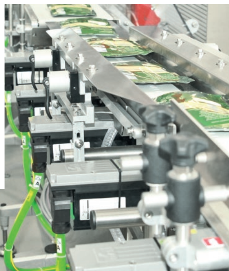
Bild 5: Innovativer Ansatz: Fördersystem mit Servotechnik anstatt mit umrichter-gesteuerten Asynchronmotoren: Die volle Integration in die Kommunikation und die Software-Lösung des Motion-Control-Verbunds, die damit verbundenen Engineering-Vorteile und die bei Weitem höhere Flexibilität wiegen höhere Produktkosten auf der Einkaufsseite auf.
