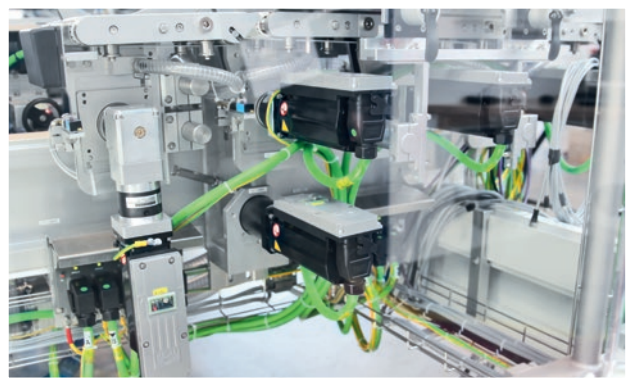
Bild 4: Die Regler-Elektronik der Lexium 62 ILM-Antriebe belastet den Schaltschrank nicht, sie sitzt Huckepack auf jedem Servomotor.
