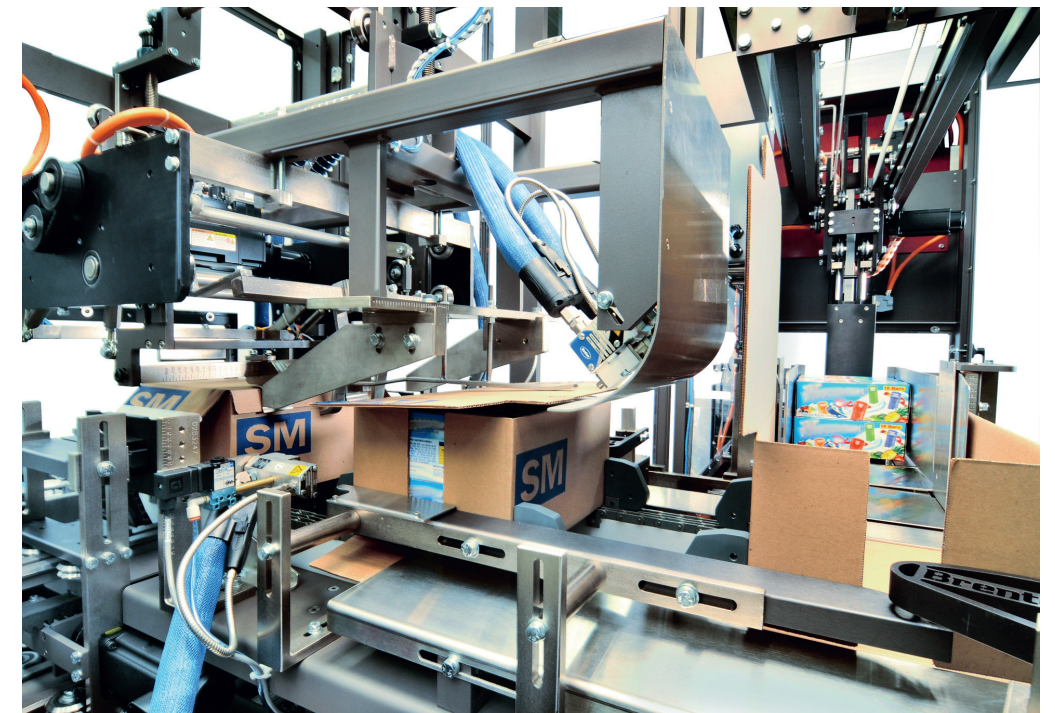
Das motorintegrierte Servoantriebssystem IndraDrive Mi erlaubt Brenton Engineering, mehr als 200 bewegliche Teile zu entfernen und die Kosten für Bauteile um ein Drittel zu senken.
