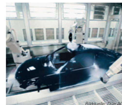
Bild 1: Exakte Sprühkopf-Positionierung und Druckregelung durch synchrone Kommunikation
